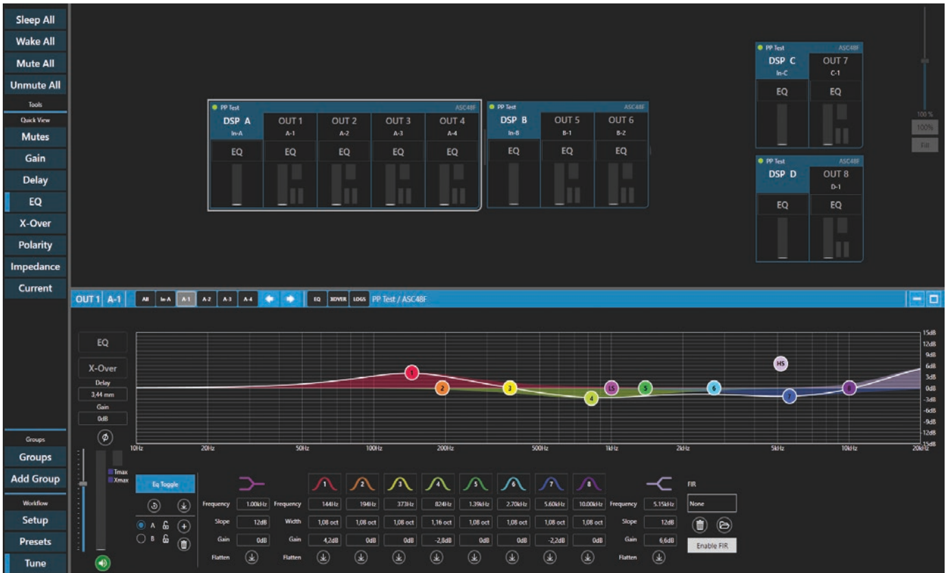
Einstellung der EQ-Funktionen in einem Ausgang Besonders praktisch für Hörvergleiche ist EQ-Toggle (links unten), womit zwischen mehreren vordefinierten Setups umgeschaltet wird (Abb. 21)
